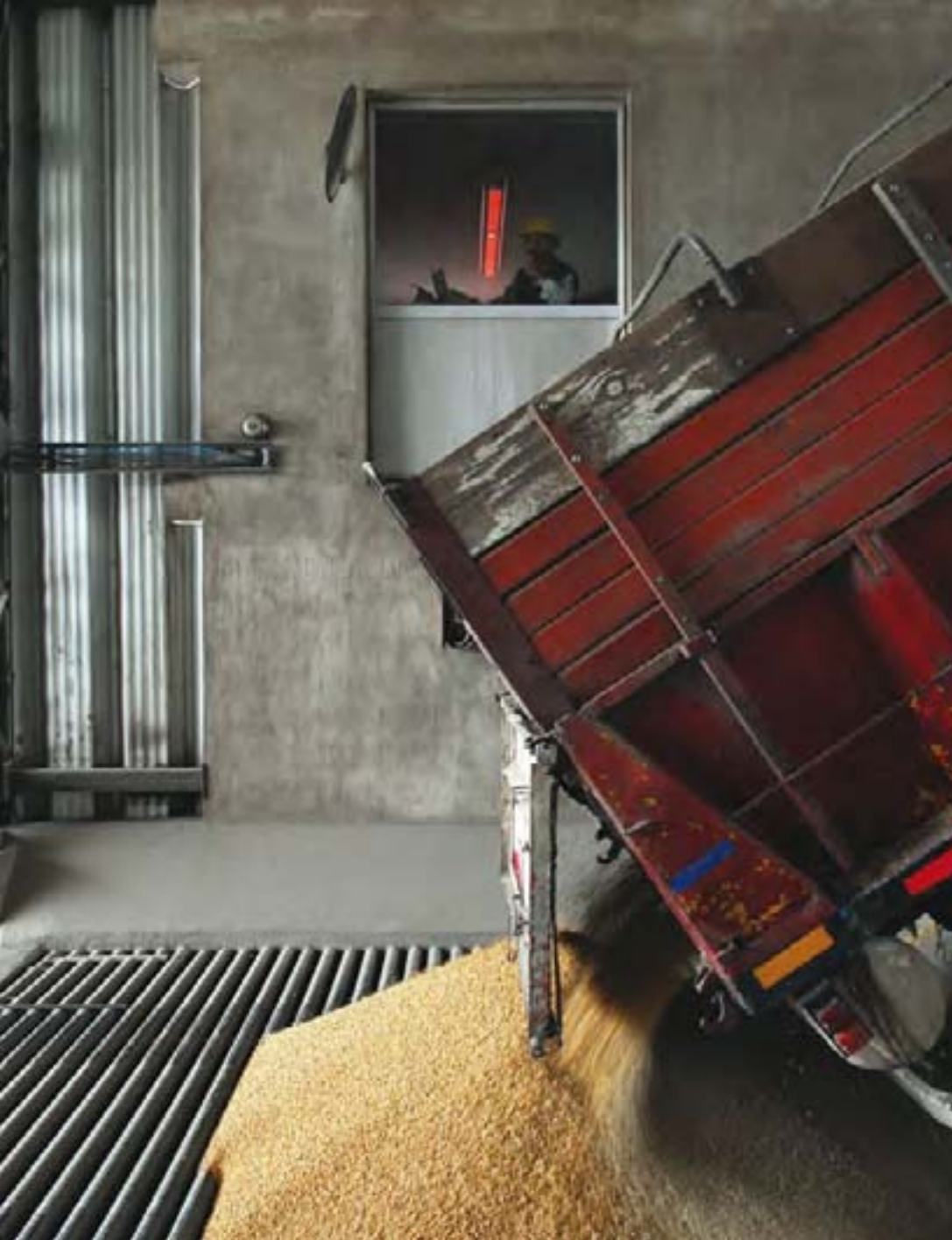
Descargando del camión a la rejilla.
