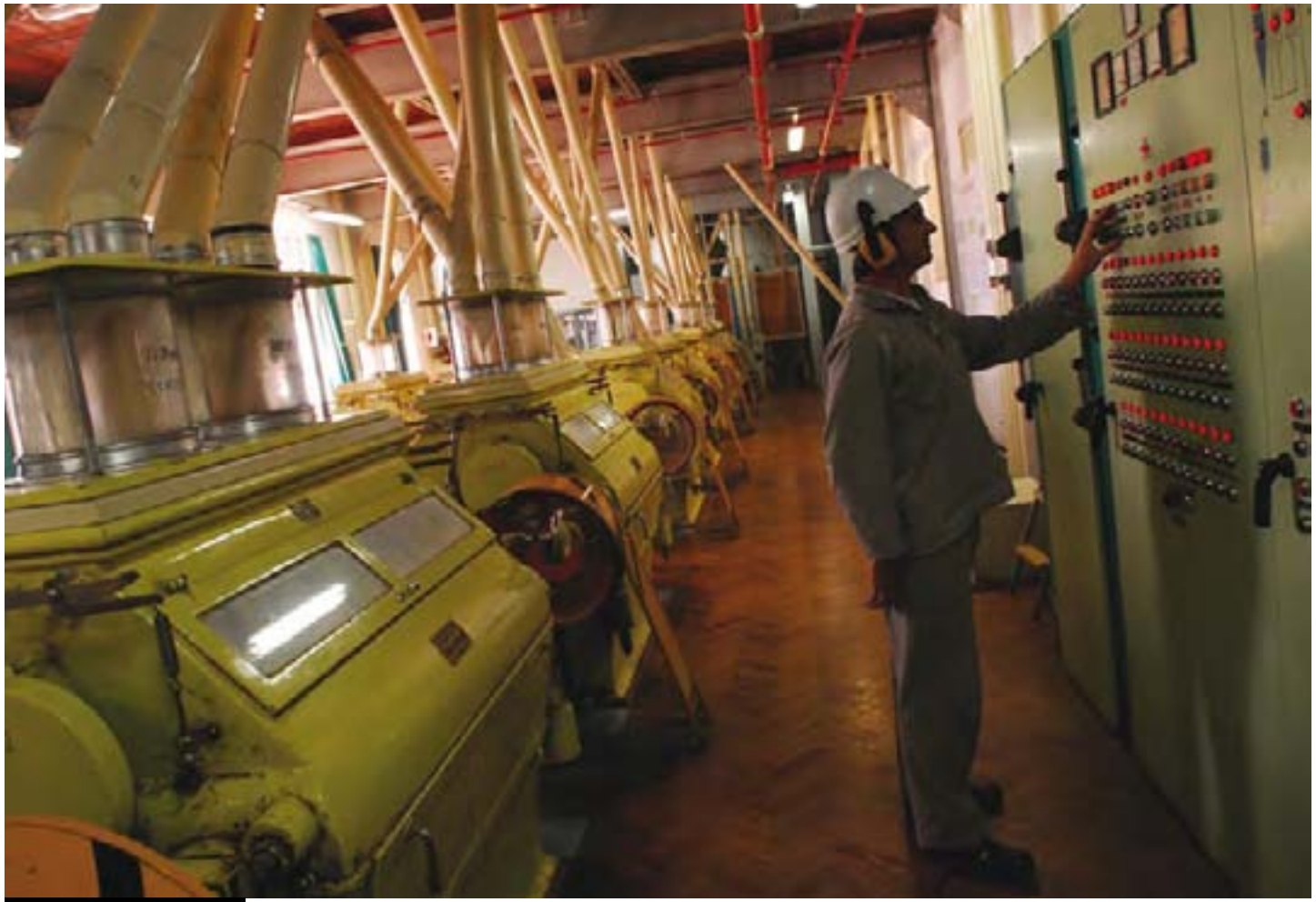
Manejo de Tablero (Orden a Máquinas, Manejo de Cilindros, Proceso de Molienda).
